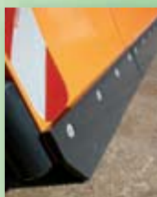
Nož iz proti obrabi odpornega jekla debeline 20 mm
